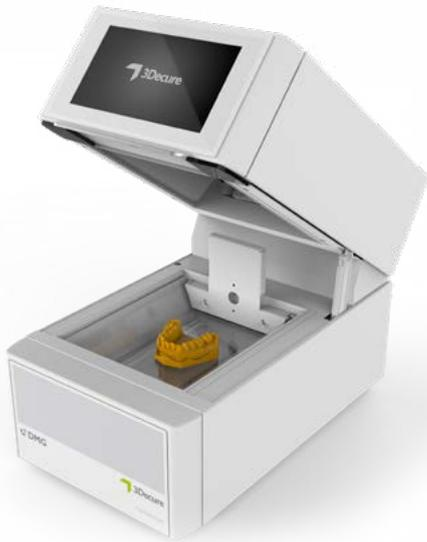
**Unidad de fotopolimerización para la polimerización final como parte supervisada y controlada del proceso.**
